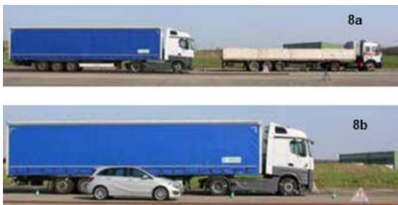
Rys. 8. Zdjęcia samochodów w chwili zakończenia hamowania (Petersen 2018, s. 55)
